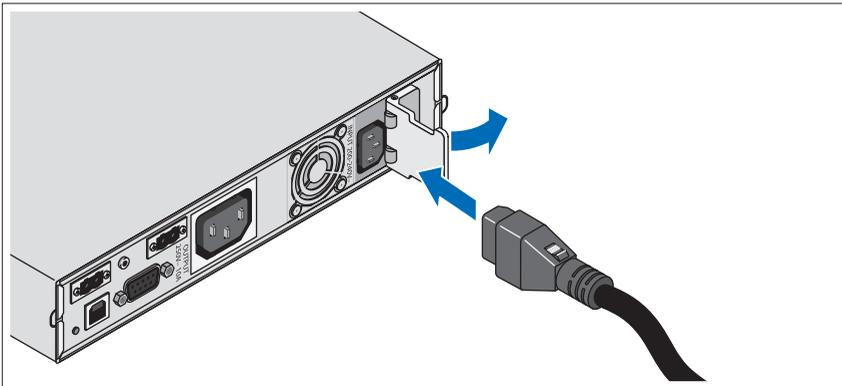
Buka pelindung sistem interlock spring-loaded untuk konektor input dan sambungkan kabel daya ke BPS.
