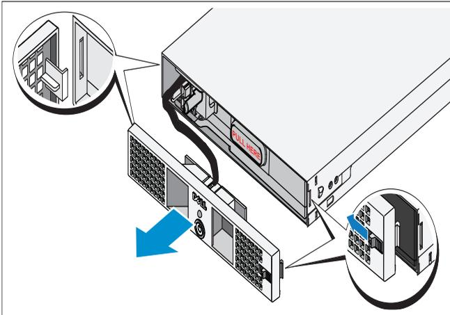
Pada sisi kanan penutup depan, geser kait ke kiri untuk menarik ke dalam kaitannya. Kaitan ini mengamankan penutup depan ke sisi kanan sasis. Tarik sisi kanan penutup depan dari sasis. Geser penutup depan ke kanan untuk melepaskan pengait. Pengait ini akan menahan penutup depan ke sisi kiri sasis.
