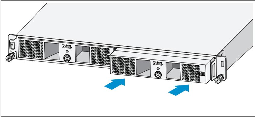
電源モジュールの背面パネルをシャーシの背面に向けて、シャーシモジュールベイへ挿入します。
