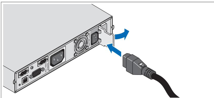
打开输入接口的装有弹簧的互锁护盖，然后将电源线连接至 BPS。
