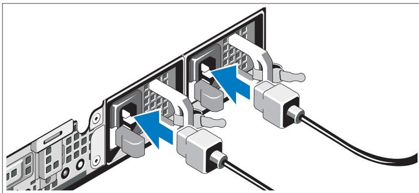
将系统的电源电缆连接到系统上。
