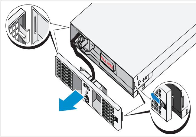
在前护盖的右侧，将门锁滑动至左侧以缩回门锁挂钩。该挂钩将护盖固定到底盘的右侧。从底盘拉动前护盖的右侧。将前护盖滑动至右侧以断开挂钩的啮合。该挂钩将护盖固定到底盘的右侧。
