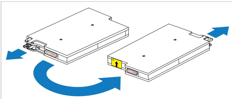
ブラインドメイトコネクタが電源モジュールシャーシの後方に向くようにバッテリーを 180° 回転させます。
