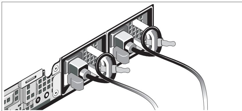
システムの電源ケーブルをループ状に曲げ（図を参照）、付属のストラップでケーブルをブラケットに固定します。ひとつの電源ケーブルの反対側をアースされた電源コンセントに接続し、もうひとつのケーブルを BPS に接続します。詳細については、66 ページの「ソリューションの配線」を参照してください。
