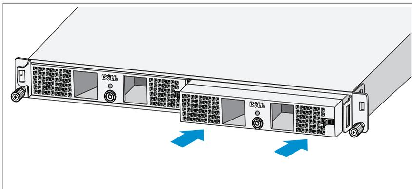
将电源模块插入底盘模块托架中，使背板朝向底盘背部。
