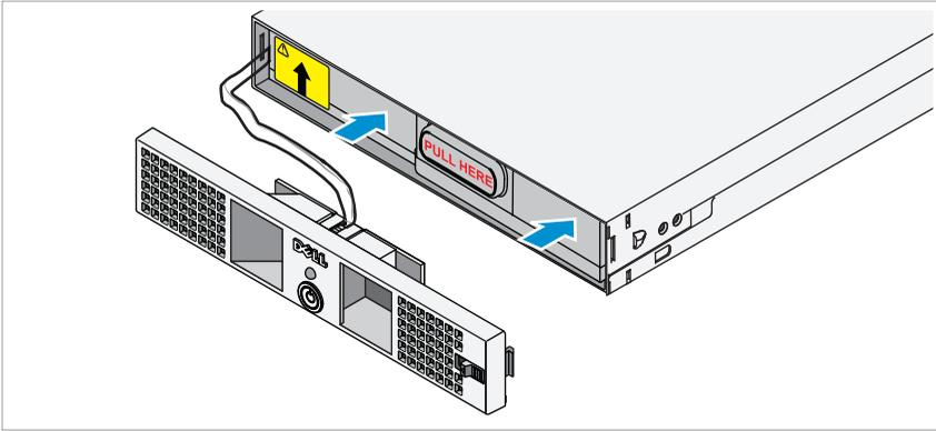
배터리와 전원 모듈을 맞추고 배터리를 다시 끼워넣습니다. 배터리가 전원 모듈에 완전히 장착되어 있는지 확인하십시오. 배터리가 전원 모듈에 완전히 삽입되지 않은 경우, 배터리 전면 덮개가 제대로 닫히지 않습니다.
