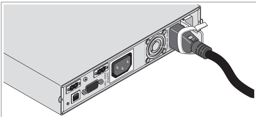
如图所示，将连接至 BPS 的电源线固定。
