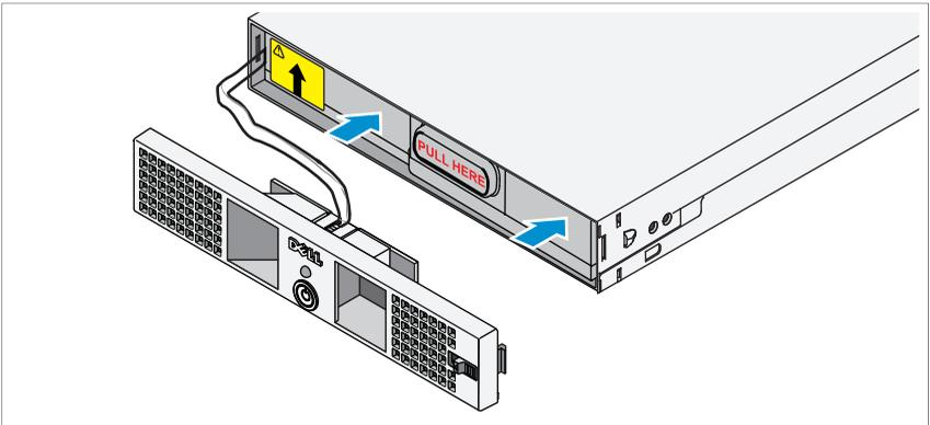
将电池与电源模块对齐，并重新插入电池。确保电池在电源模块中完全就位。如果电池未完全插入电源模块，则无法正确关闭电池前护盖。
