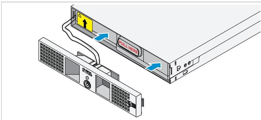
バッテリーを電源装置に揃え、再挿入します。バッテリーが電源モジュールに完全に装着されていることを確認します。バッテリーが電源モジュールに完全に装着されていない場合、バッテリーの前面カバーが正しく閉じません。
