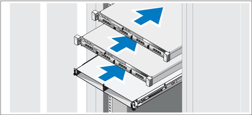
레일을 조립하고 랙에 시스템과 백업용 전원 공급 장치 (BPS) 를 설치합니다 . 안전 지침 및 솔루션과 함께 제공된 랙 설치 지시사항을 따르십시오 .
