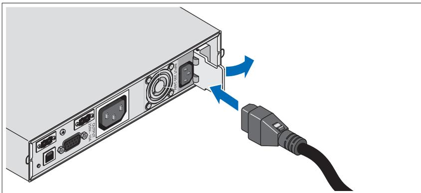
入力コネクタのパネ付きインターロックカバーを開き、電源ケーブルを BPS に接続します。
