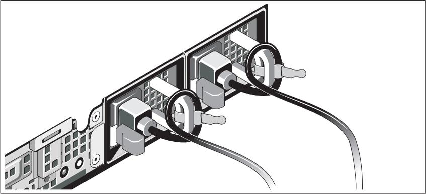
시스템 전원 케이블을 그림에 표시된 대로 루프 모양으로 구부리고 제공된 스트랩을 사용하여 브래킷에 케이블을 고정시킵니다. 접지된 전원 콘센트에 전원 케이블 1 개의 한쪽 끝을 연결하고 케이블의 다른 한 쪽은 BPS에 연결합니다. 자세한 내용은 85 페이지의 "솔루션 케이블 연결"을 참조하십시오.
