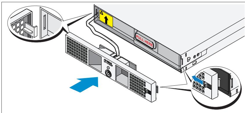
**⚠ 警告：**出于安全考虑，一旦插入并连接电池组，就必须立即装上电源模块前护盖。
