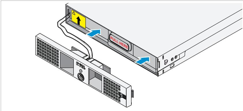
Luruskan baterai dengan modul daya dan masukkan kembali baterai. Pastikan baterai terpasang sepenuhnya pada modul daya. Jika baterai tidak terpasang sepenuhnya pada modul daya, penutup depan baterai tidak dapat menutup dengan baik.
