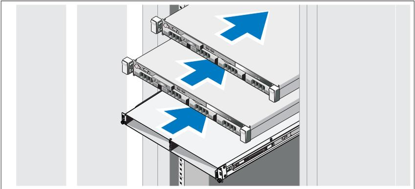
レールを組み立て、システムとバックアップ電源装置（BPS）をラックに取り付けます。ソリューションに付属しているマニュアルの安全にお使いいただくための注意事項、およびラック取り付け手順に従ってください。
