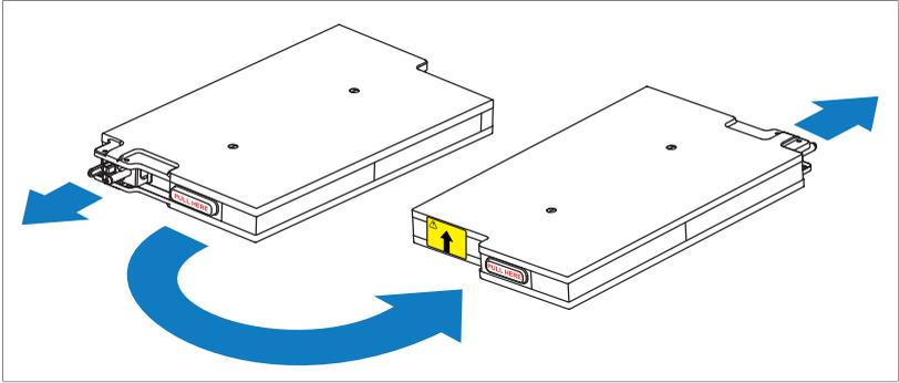
将电池转动 180°，使得盲插接头朝向电源模块底盘的背部。
