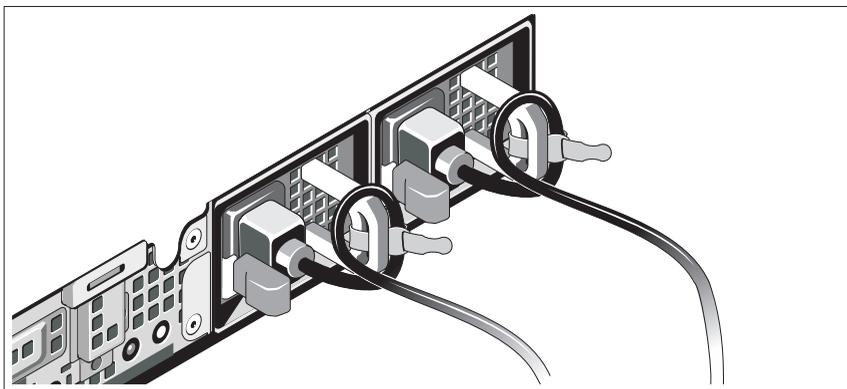
如图所示，将系统电源电缆弯成环状，并使用提供的扎带将其固定到支架上。将一根电源线的另一端插入接地插座，将另一根电源线插入 BPS。有关详情，请参阅第 27 页的“解决方案布线”。
