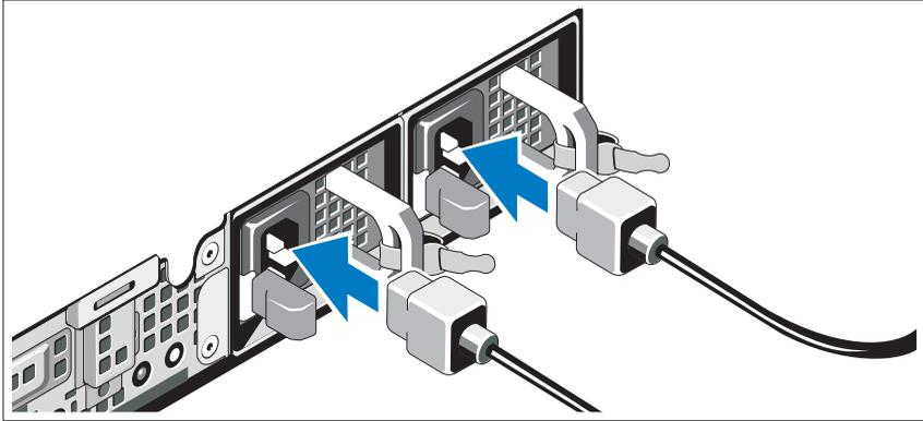
Sambungkan kabel daya sistem ke sistem.
