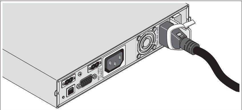
Tahan kabel daya yang terhubung ke BPS seperti yang ditampilkan dalam gambar.
