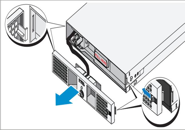
전면 덮개의 우측에서, 래치 홀이 들어가게 하려면 래치를 왼쪽으로 밀어주십시오. 이 홀은 전면 덮개를 새시의 우측에 고정합니다. 새시에서 전면 덮개의 우측 부분을 잡아당깁니다. 홀을 분리하려면 전면 덮개를 우측으로 밀어냅니다. 이 홀은 전면 덮개를 새시의 좌측에 고정합니다.
