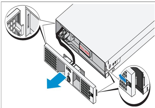
前面カバーの右側にあるラッチを左にスライドさせてラッチフックを引き込みます。このフックは前面カバーをシャーシの右側に固定しています。前面カバーの右側をシャーシから引き離します。前面カバーを右側へスライドさせてフックを外します。このフックは前面カバーをシャーシの左側に固定しています。
