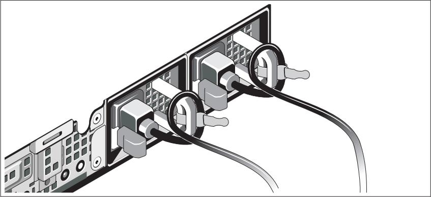
Tekuk kabel daya sistem hingga melingkar seperti terlihat pada gambar dan tahan kabel pada braket menggunakan pengikat yang disediakan. Tancapkan ujung lainnya dari kabel daya tersebut ke outlet listrik yang telah terhubung ke ground dan ujung lainnya ke BPS. Untuk informasi lebih lanjut, lihat "Pemasangan Kabel Perangkat Solusi" di halaman 47.
